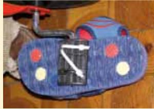
*Das Dreirad wird mit Fußschalen versehen. Mit einem Klettverschluss wird der Schuh fixiert.*
